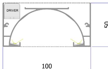
**MV - PERFIL - 300 x 100 x 50 mm** (ACOMPANHA: TAMPAS FECHADAS E SUPORTES DE FIXAÇÃO TETO/PAREDE | NÃO INCLUSO: FITAS LED E DRIVERS)
