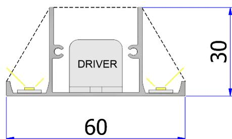
NP2 - PERFIL - 400 x 60 x 30 mm ( ACOMPANHA: TAMPAS CHANFRADAS E SUPORTES DE FIXAÇÃO TETO/PAREDE | NÃO INCLUI: FITAS LED E DRIVERS )
