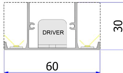
**NP2 - PERFIL - 400 x 60 x 30 mm** ( ACOMPANHA: TAMPAS RETAS E SUPORTES DE FIXAÇÃO TETO/PAREDE | NÃO INCLUSO: FITAS LED E DRIVERS )
