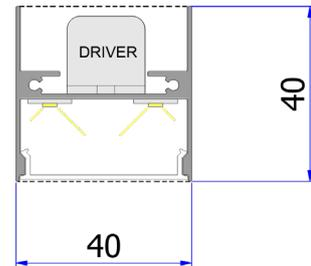
**EVO1 - PERFIL - 1000 x 40 x 40 mm** ( ACOMPANHA: TAMPAS E SUPORTES DE FIXAÇÃO TETO/PAREDE | NÃO INCLUSO: FITAS LED E DRIVERS )
