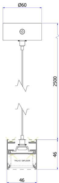
**EVO2 - PERFIL PENDENTE COM CABO - 3000 x 46 x 46 mm** ( ACOMPANHA: TAMPAS E BASES DE FIXAÇÃO | NÃO INCLUSO: SPOTS, LÂMPADAS, FITAS LED E DRIVERS )
