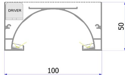
**MV - PERFIL - 300 x 100 x 50 mm** (ACOMPANHA: TAMPAS ABERTAS E SUPORTES DE FIXAÇÃO TETO/PAREDE | NÃO INCLUSO: FITAS LED E DRIVERS)
